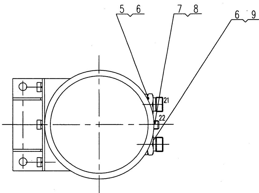
XZ16K. 41. 6 干燥器安装 Air Dryer Assembly
