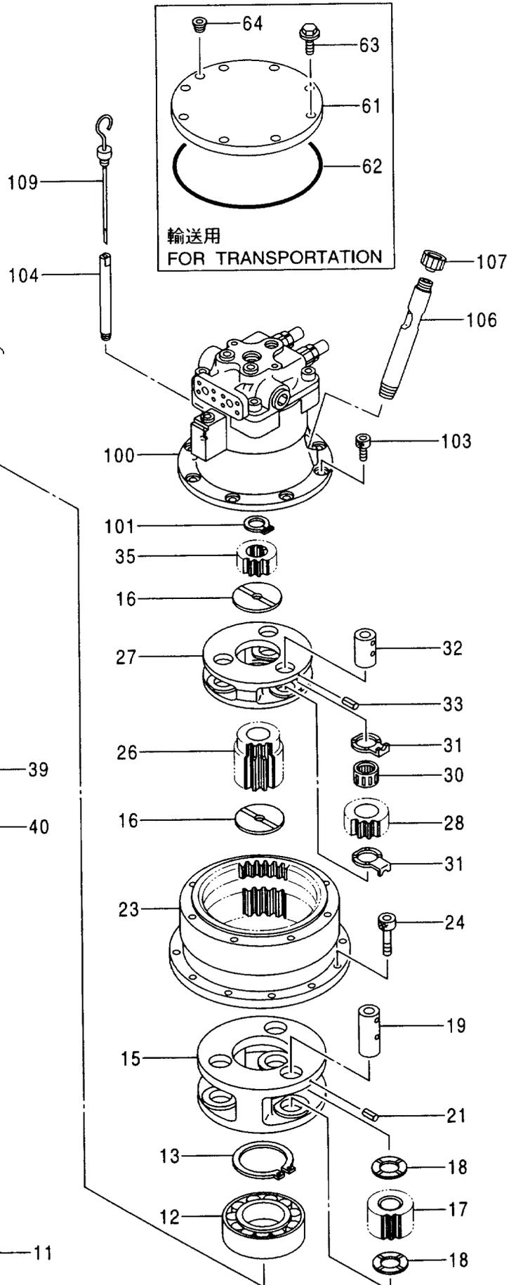
旋回装置取付部品
